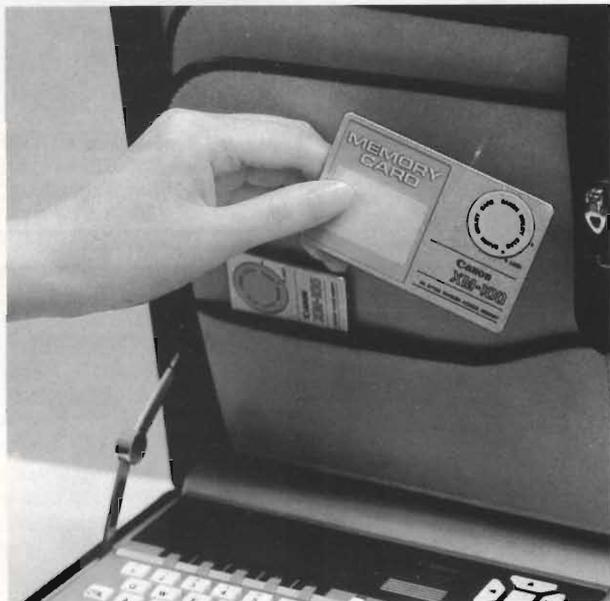
Le rivoluzionarie Memory Card dell'X-07 sono delle schede sottili, delle dimensioni di una carta di credito, che vanno inserite nel retro dell'X-07. Ognuna di queste schede contiene RAM (random access memory) con una capacità di 4 K bytes, cioè circa 4.000 caratteri. Questa memoria è alimentata da una sottile batteria al litio della durata di almeno 18 mesi, che consente di estrarla dall'X-07, quando fosse necessario, senza perdere i contenuti.
