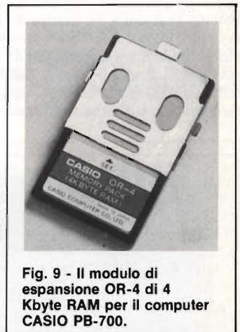
Fig. 9 - Il modulo di espansione OR-4 di 4 Kbyte RAM per il computer CASIO PB-700.
